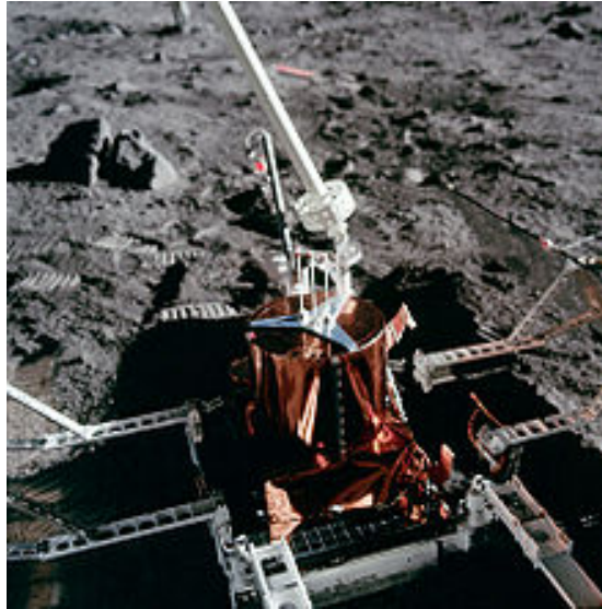
Sismografo installato sulla Luna dagli astronauti dell'Apollo 11 nella loro prima missione. Dispositivi simili vennero trasportati in tutte le altre missioni del programma Apollo
